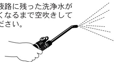
※特に、水和剤・石灰硫黄合剤・マシン油剤を使用した場合は、薬液が完全になくなるまで真水(水道水)を噴霧して本器内を洗浄してください。薬液がバルブ本体、ノズル内部に残ると固化して故障の原因になります。
