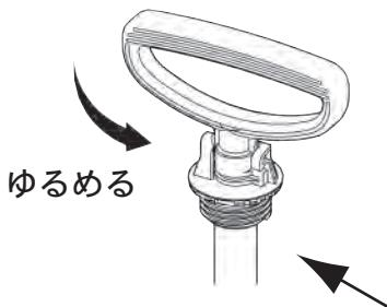
図A 空気吹き上げ防止装置
