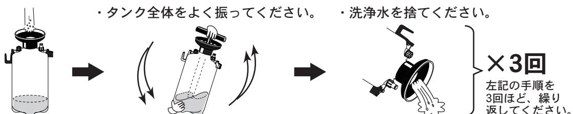
②本器の通液路を洗浄するために再度タンクに真水(水道水)を入れて加圧し、約1分間噴霧してください。
