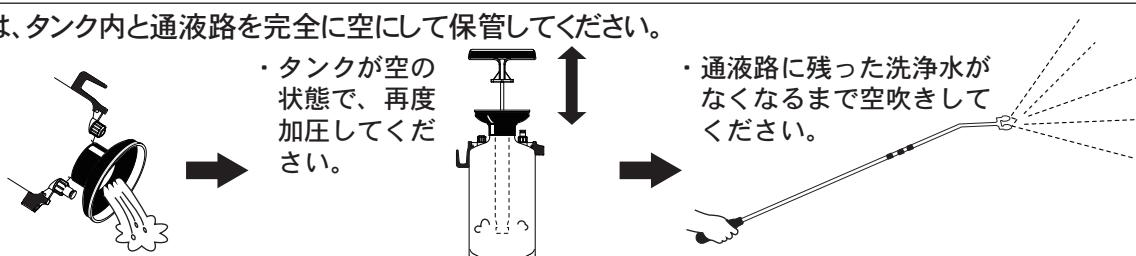
※特に、水和剤・石灰硫黄合剤・マシン油乳剤を使用した場合は、薬液が完全になくなるまで真水(水道水)を噴霧して本器内を洗浄してください。薬液がバルブ本体、ノズル内部に残ると固化して故障の原因になります。
