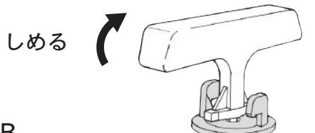
※ポンプを取り付けるときは、ロックしていない位置でハンドルを締めてもロック部の強度は十分にあります。
