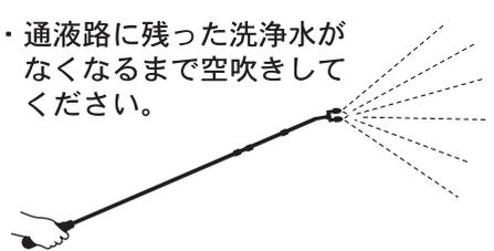
※特に、水和剤・石灰硫黄合剤・マシン油乳剤を使用した場合は、薬液が完全になくなるまで真水（水道水）を噴霧して本器内を洗浄してください。薬液がバルブ本体、ノズル内部に残ると固化して故障の原因になります。
