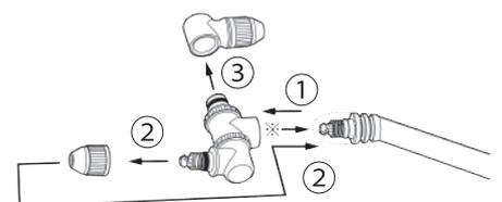
※L型回転部を外すときは、L型回転部固定ナットを右図の様に完全にゆるめてから、ノズルを確実に後方に向け、A部のつめを折らないように外してください。
