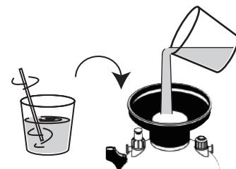
③液剤が均一になるようよくかき混ぜた薬液をタンクに移し替えます。
