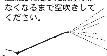
※特に、水和剤・石灰硫黄合剤・マシン油乳剤を使用した場合は、薬液が完全になくなるまで真水（水道水）を噴霧して本器内を洗浄してください。薬液がバルブ本体、ノズル内部に残ると固化して故障の原因になります。
